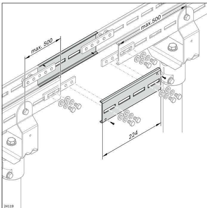
Le module de montage sert à la mise en place et à la fermeture/l'ouverture de la chaîne. Il est installé à un emplacement au choix de la section de transport, de manière à être parfaitement accessible lors du fonctionnement. Le module de montage doit être prévu pour les sections avec entraînements sans sac de chaîne (p. ex. convoyeur à serrage).
